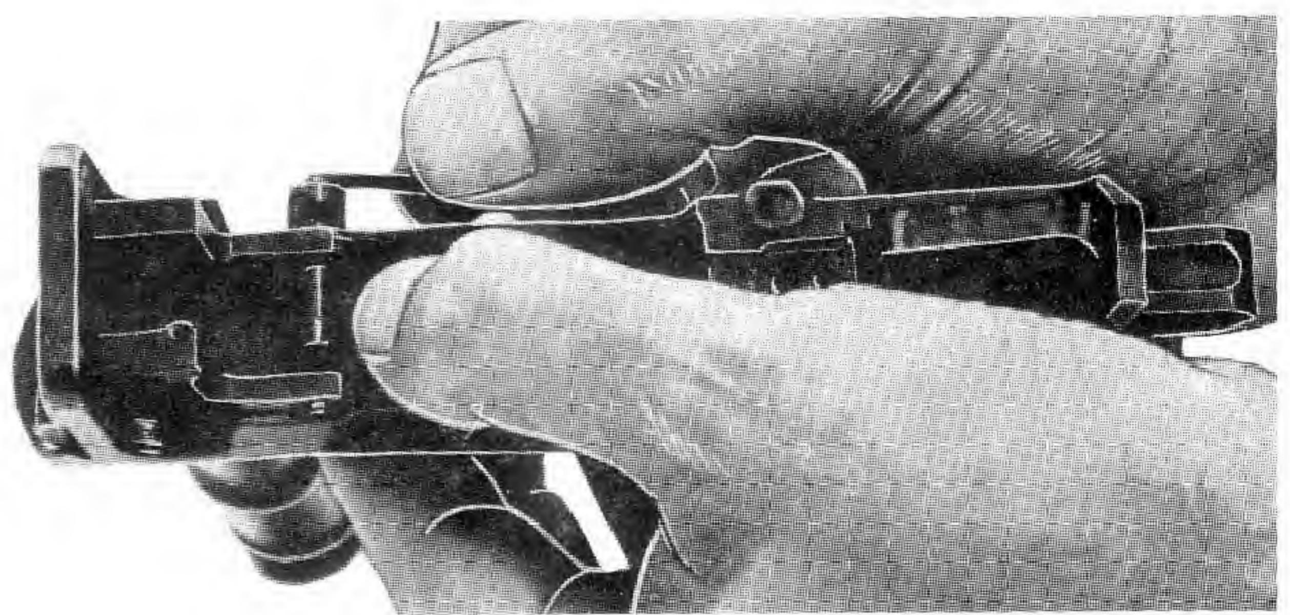
Sl. 81 – Odvajanje regulatora paljbe-kočnice od usadnika
